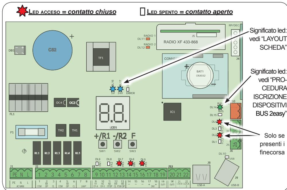
**STOP** - In configurazione di default l'ingresso STOP è un ingresso di sicurezza con contatto N.C. (Normalmente Chiuso). Il LED corrispondente deve essere **ACCESO** in condizione di automatismo a riposo e spegnersi all'attivazione del dispositivo connesso.
