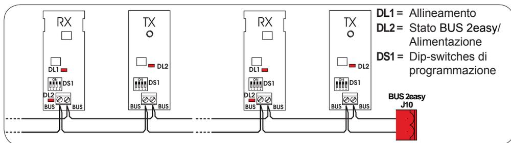
La connessione degli encoder BUS 2easy va effettuata utilizzando i cavi bipolari a corredo.
