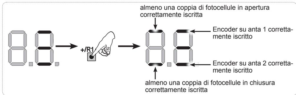
Per controllare il buono stato del collegamento BUS 2easy, verificare i led sulla scheda:
