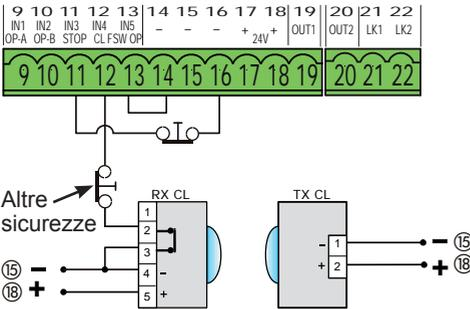
Una coppia di fotocellule in chiusura, una in apertura ed una in apertura/chiusura.
