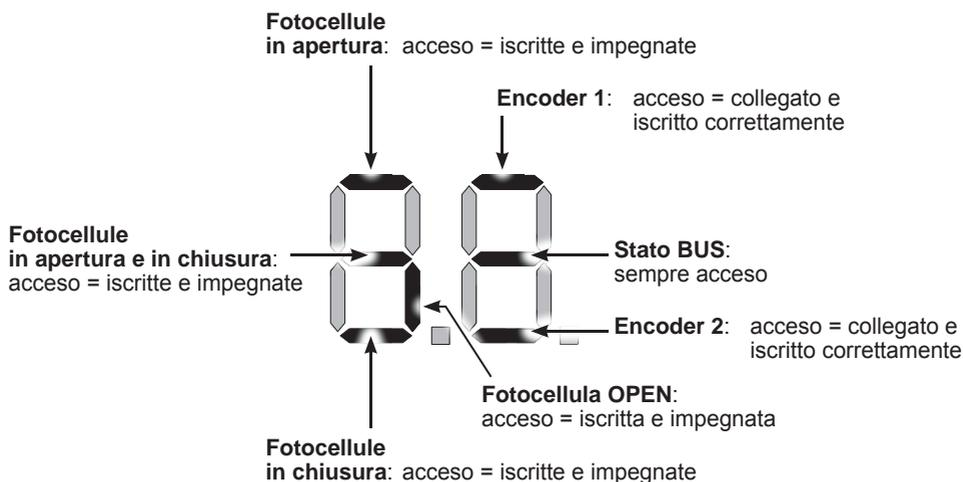
**Fig.** Visualizzazione stato BUS 2easy da funzione **bu**: ogni segmento del display segnala un tipo di dispositivo.
